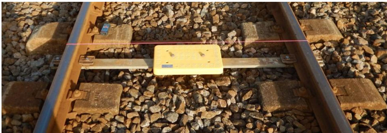
Eksempel på balise monteret på skinner mellem 2 sveller
